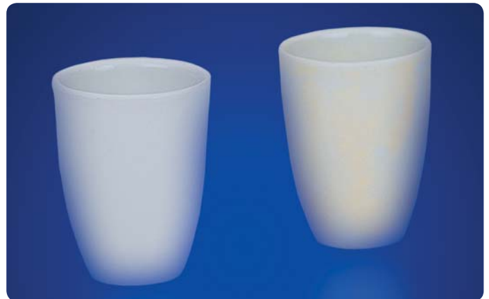
Tiegel eines Wettbewerbers vor (links) und nach (rechts) der thermischen Behandlung, mit deutlichen Verfärbungen der Glasur nach Erstanwendung.
